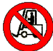
Vietato ai carrelli di movimentazione
